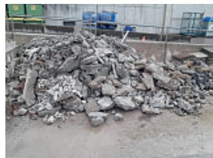
Betonabbruch, als beste Baurestmassen-Qualität, wird entweder zu Betongranulat und Recyclingbeton weiterverarbeitet oder auch für Tragschichten, Drainageschichten, Wegebau und hochwertige Künettenverfüllungen verwendet.
